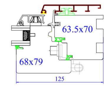
Coupe verticale d'un raccord horizontal pour faciliter le transport
