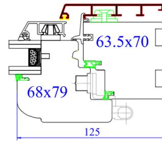
Coupe verticale d'un raccord horizontal pour faciliter le transport
